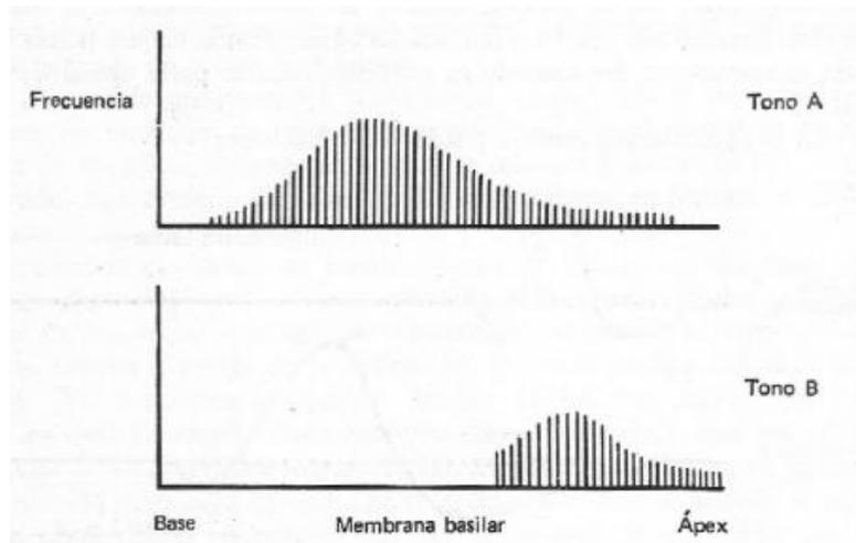
El diagrama superior y el inferior representan la descarga de fibras del nervio auditivo ante dos frecuencias. La codificación de tonos es entonces un problema asociado a la activación de un patrón neuronal complejo. La discriminación de intensidades ante dos tonos idénticos sería:
