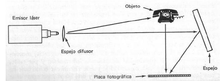
La interacción de la luz reflejada por el objeto y la luz reflejada por el espejo en la estructura de la placa fotográfica, crea en ésta un
